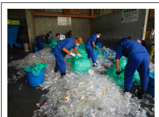
ペットボトル破袋作業 汚れたペットボトルを取り除く
